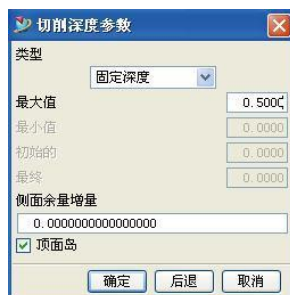
图 13-19 设置切削深度
